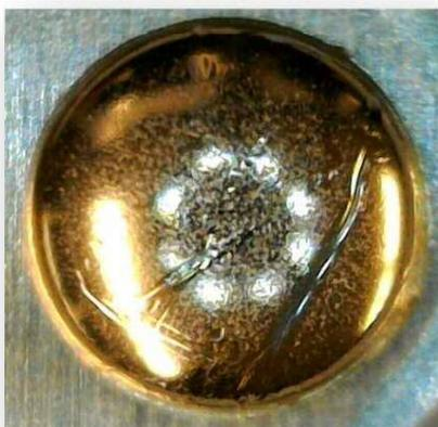
照明やカメラの映り込みを画像処理で補正し、キズを見やすくする
