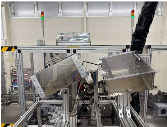
カラクリ技術を活用した 自動機への部品供給
